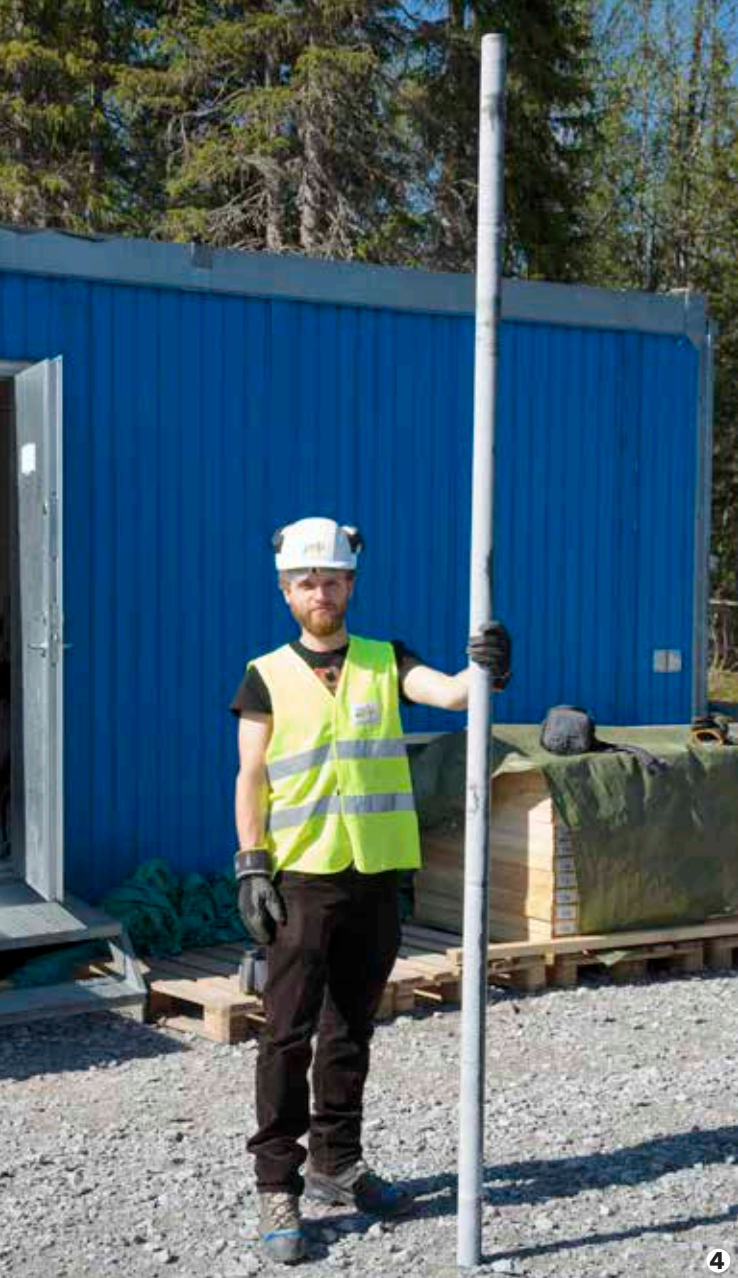
Bild 4: Kärnupptagningen var genomgående bra vid borrhningen av COSC-1. Här förevisar David Sicken en 3 meter lång helt obruten borrhkärna.
