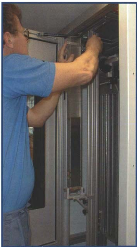
Sedimentscannern ombord på SGU:s fartyg S/V Ocean Surveyor laddas med en sedimentkärna för digital röntgenavbildning. Foto F. Klingberg 1999.
