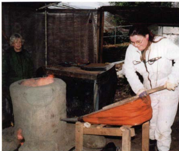
Bild 6. Blästugn för järnframställning, här använd i vår experimentverksamhet. Dess konstruktion är baserad på information från arkeologiska utgrävningar. Foto Peter Kresten.
