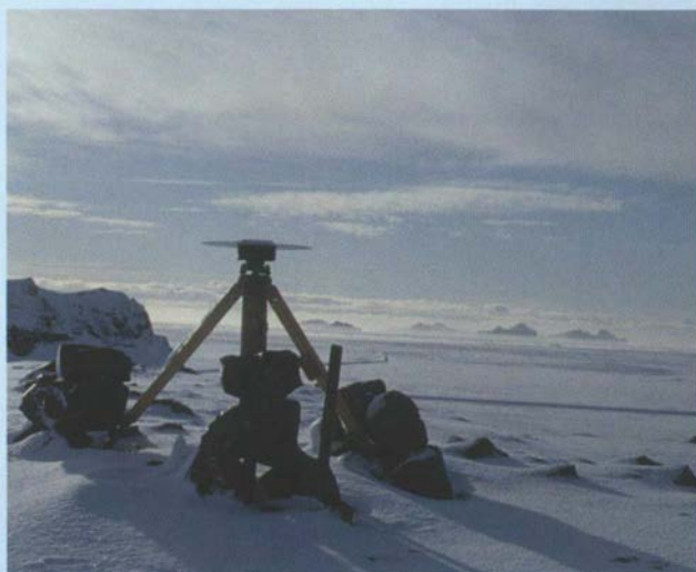
Figur 5. GPS mätningar vid Eyjafjallajökull-stationen Hamragarður (HAMR) under vintern. Vestmanaöarna ligger i bakgrunden. Antennen hålls på plats med ett flertal stenar vilket är en nödvändighet om man vill behålla den. Foto Erik Sturkell.
