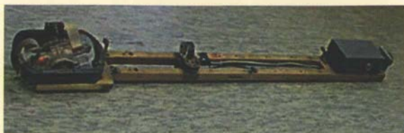
Magnetiskt instrument för ubåtsjakt - SGUs första flygburna magnetometer. Instrumentet blev modifierat för geofysiska ändamål i slutet på 1950-talet. Foto Sören Byström.
