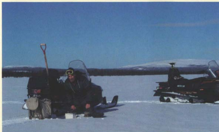
Tyngdkraftsmätning med hjälp av snöskoter på vidsträckta myrmarker i Nattavaara trakten, Lappland. Foto Sven Aaro.
