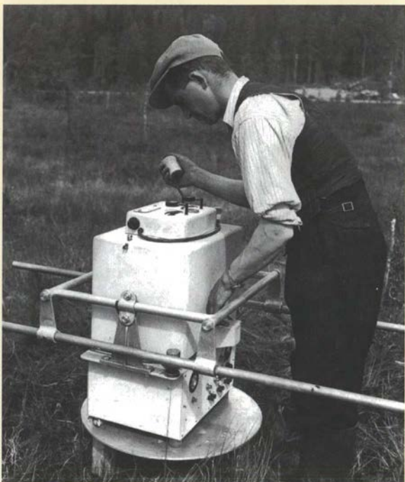
Tyngdkraftsmätning med Bolidengravimetern på 1940-talet. Gravimetern vägde cirka 60 kg vilket förklarar de kraftiga bärstängerna. Boliden AB:s arkiv.
