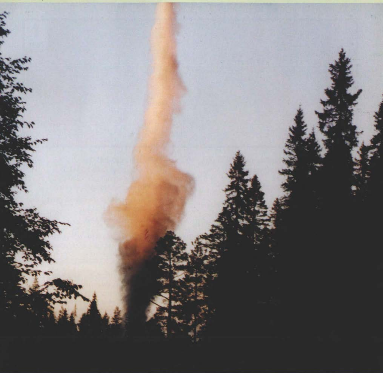
Figur 2. Sprängning av dynamitladdning för en djup seismisk undersökning i Norrbotten. I idealfallet sett bör ingen energi förloras genom att material transporteras upp ur borrhålet.
