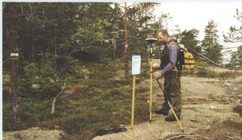
GPS-avvägning av Högsta kustlinjen, 286 m ö.h., på Skulebergets nordvästra del. Vandringsleden bidrar till att hålla vegetationen i schack. På hällen ligger två barometrar och en GPS handmottagare, vilka också användes vid höjdbestämningsarna. Foto Karin Grånäs 2002.
