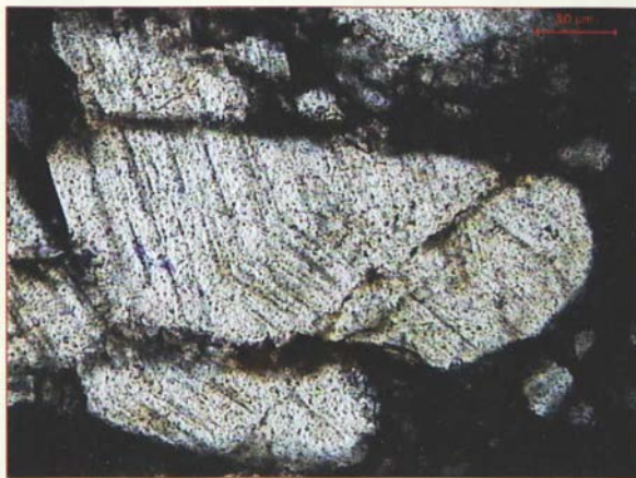
De tunna parallella ränderna i kvartskornet är chocklameller – det avgörande beviset för att ett meteoritnedslag drabbade berggrunden!
