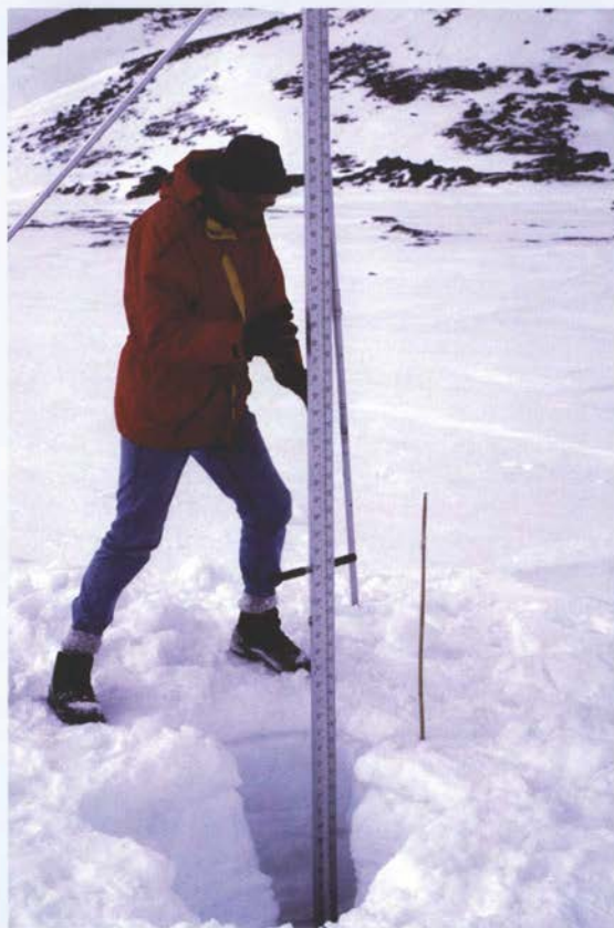
Avvägning kan genomföras året runt, bara man har haft framförhållning och placerat ut bambustickor så att man vet var man skall gräva.
