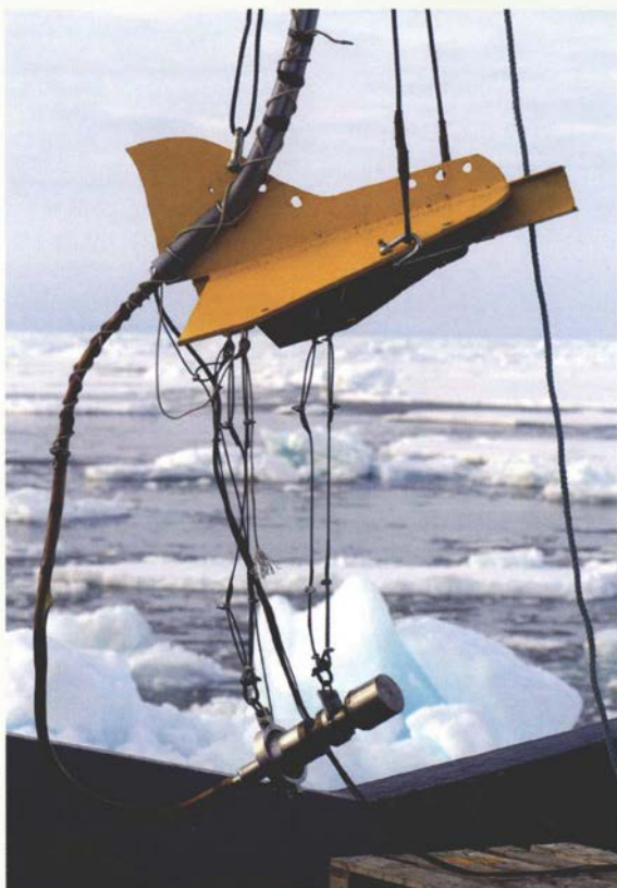
Specialtillverkad depressor för att hålla ner den seismiska luftkanonen under Odens propellerturbulens. Luftkanonen hänger under depressorn i vajrar. Foto Martin Jakobsson.
