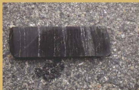
Del av borrhärd, ungefär 4 cm bred, från Fäboliden. I denna malm uppträder guld ofta ihop med sulfidmineralet arsenikkis ( \text{FeAsS} ) som syns som silvervita steck i den mörka bergarten.
