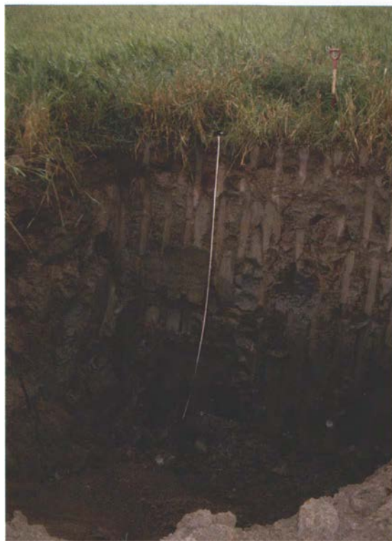
I markprofilens övre del syns den sura sulfatjord som bildas då sulfidhaltiga sediment oxiderar. Denna jordmån kännetecknas av vertikala sprickor vilka är täckta av järnhydroxid. Längst ner i gropen har sulfidmineralen inte oxiderat och jordarten har därför behållit sin svarta färg.
