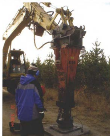
VIBISIST-system som genererar seismiska signaler under datainsamlingen. Foto: Mahdiah Dehghannejad
