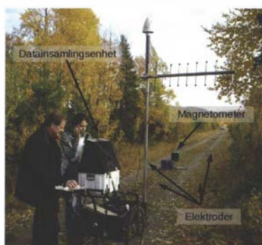
Lars Dynesius and María García jobbar på magnetotelluriska fältmätningar med EnviroMT systemet i Kristinebergsområdet under hösten 2008. Foto: Tobias Bauer
