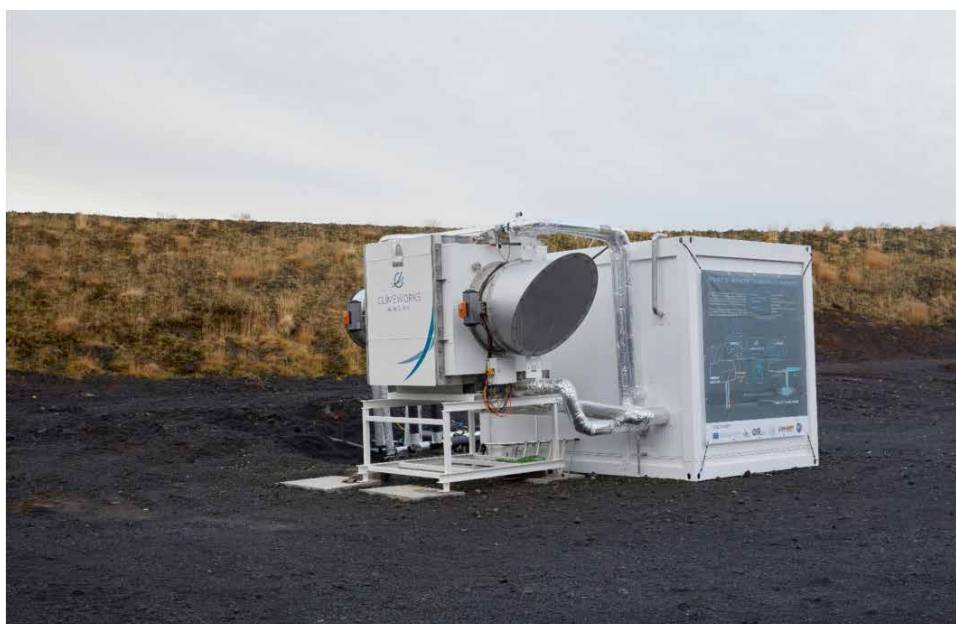
Bild 3: Bilden visar en av de enheter som samlar in koldioxid. Denna blandas sedan med vatten till bubbelvatten vilket pumpas ner i basalten under kraftverket Hellisheiði. Enheten på bilden har en kapacitet av 50 ton koldioxid per år. Bilden kommer från Climeworks.
